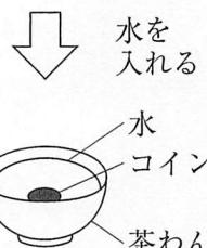
1. コインからの光が水面で屈折し、そのときの屈折角が入射角より小さいため。
